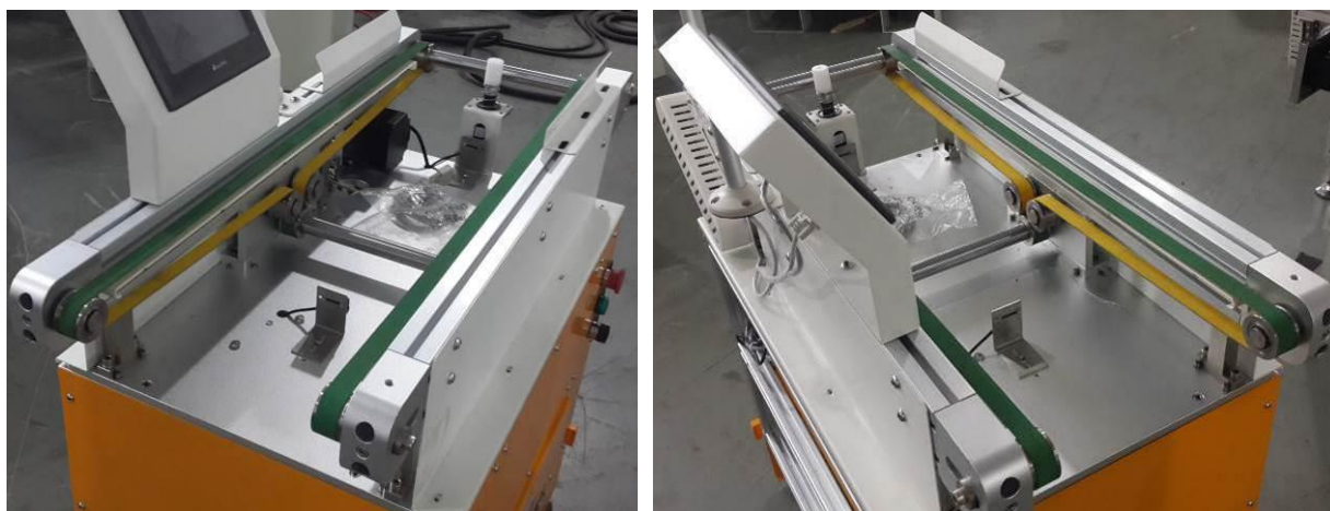
图 1-8 AGV 机器人上部输送线安装完成效果图
